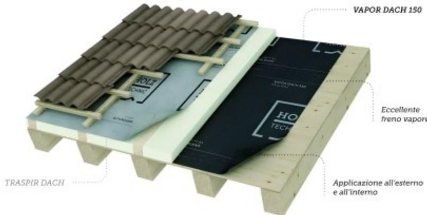
Il telo freno vapore è costituito da tre strati di protezione in polipropilene ed è concepito per applicazione sia sul lato interno, sia su quello esterno di tetto e pareti. Regola il passaggio dell'umidità, evitando la formazione di condensa interstiziale all'interno del pacchetto coibente.
