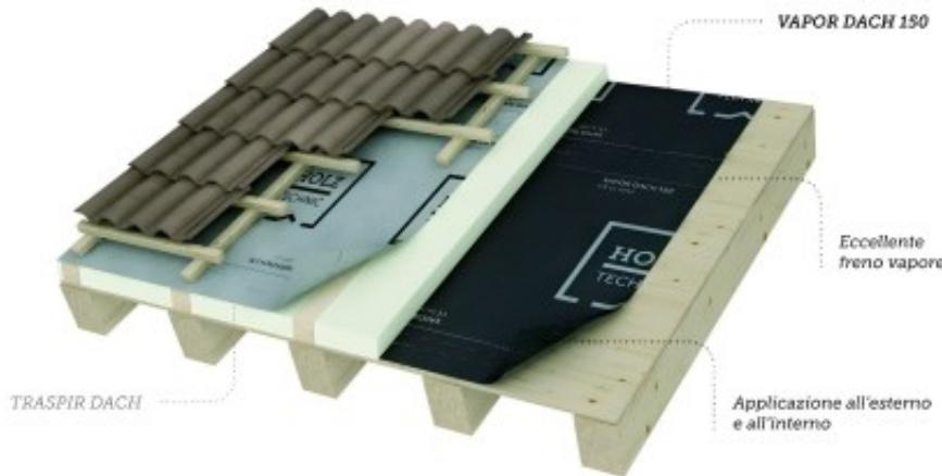
Il TRASPIR 150 è altamente traspirante e ottimizza la tenuta all'aria bloccando il passaggio di flussi d'aria indesiderati proteggendo la struttura.
