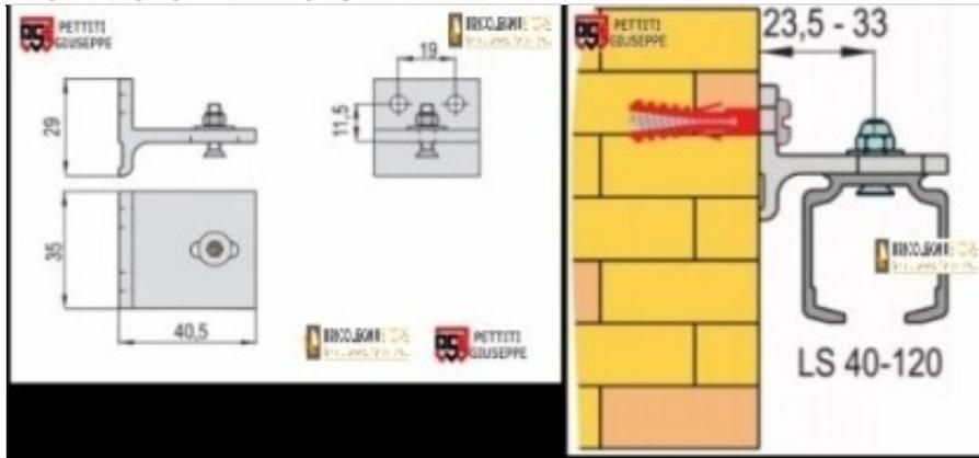
Supporto a parete per monorotaie di qualsiasi marca. Permette di distanziare dal muro lo scorrimento della porta per permettere l'allontanamento (es. per battiscopa o comandi interruttori a muro)
