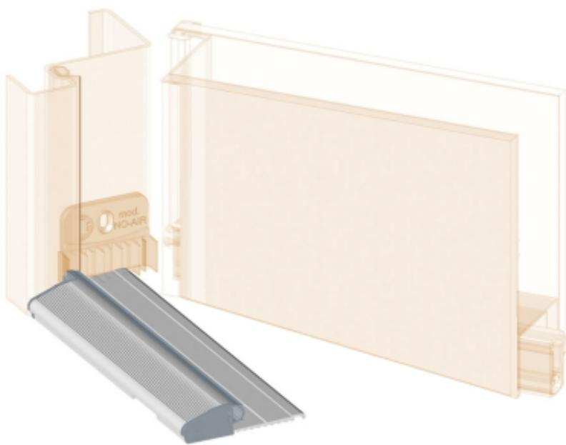
Sistema antipioggia ideato per l'installazione anche su porte già esistenti dove sia necessario inserire una soglia drenante. La soglia Ulisse Light va in battuta sull'anta della porta con una morbida guarnizione in silicone autoestinguente.
