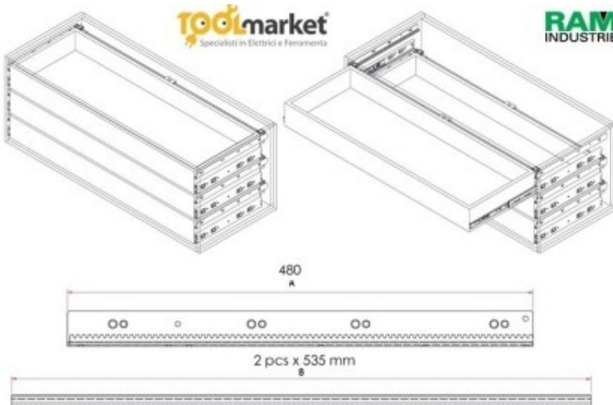
Sincronizzatore in PVC a montaggio posteriore; Cremagliera a montaggio laterale, verniciatura bianca
