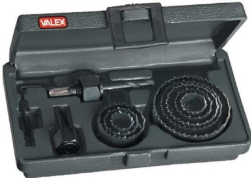
Seghe a Tazza per Legno Set 11 Pezzi da 19 mm a 64 mm; In acciaio brunito a corpo unico; Ottima per forare legno, plastica, cartongesso; Altezza totale 24mm; Il Set Include: 8 tazze Ø 19-22-29-32-38-44-51-64mm; 2 adattatori; 1 punta di centraggio con codolo circolare; 1 chiave esagonale.
