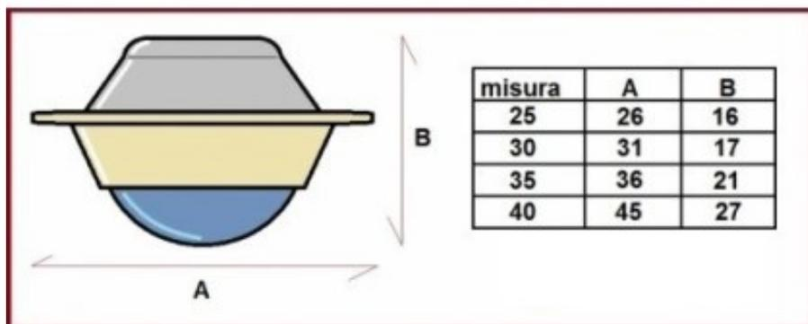
Ruota sfera in acciaio su piastra in ferro ottonato. Con cuscinetti a sfera nella base. disponibile nelle seguenti varianti: 25mm. (portata kg15); 30mm. (portata kg20); 35mm. (portata kg25); 40mm. (portata kg30)
