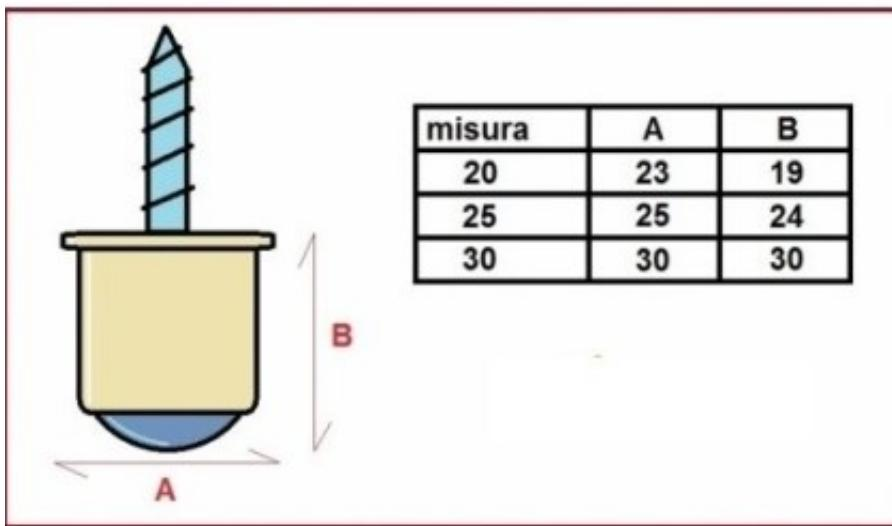
Ruota sfera su piastra in ferro ottonato con vite a legno Con cuscinetti a sfera nella base. disponibile nelle seguenti varianti: 20mm. (portata kg20); 25mm. (portata kg25); 30mm. (portata kg30);
