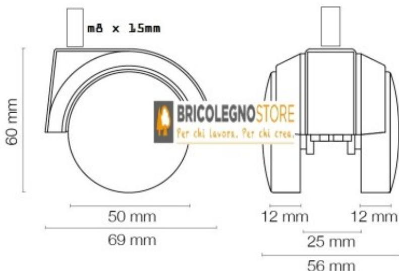
Ruota doppia nylon Ø 50, tipo pesante, ideale su parquet per la bicomposizione in gomma morbida che non graffia le superfici delicate con gomma e autobloccante. Con perno M8x15. Portata max: kg.65
