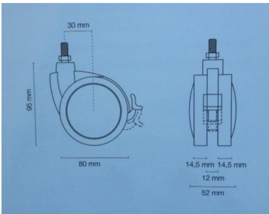
Ruota doppia in nylon diametro 80 mm. Portata kg 80. Attacco piastra o perno filettato M8 (con e senza freno). Disponibile con le seguenti varianti: Con perno filettato; Con perno filettato e freno; Con piastra; Con piastra e freno. Produttore: MACO ITALY
