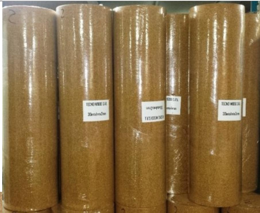
Prodotto Naturale, Antistatico, Antiallergico, Biocompatibile. Al contrario di altri isolanti sintetici non rilascia solventi o particelle nocive. Gradevole al tatto puo essere posato a vista come insonorizzante fonoassorbente e anticondensa oppure into
