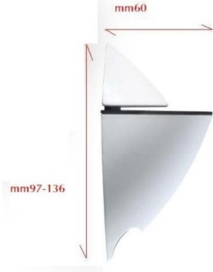
Reggimensola in pressofusione di alluminio dal design moderno eccellente per il fissaggio di mensole in cristallo, ma anche in legno (apre fino a 38 mm). Colore: cromo lucido. Portata 2 pz - kg 40
