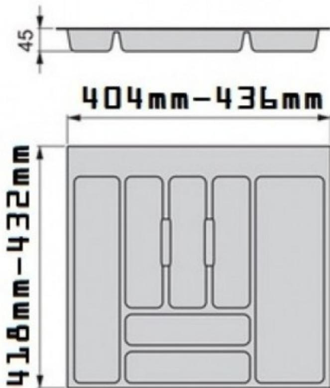
Portaposate termoformato per cassetti cucina spessore 45 mm
