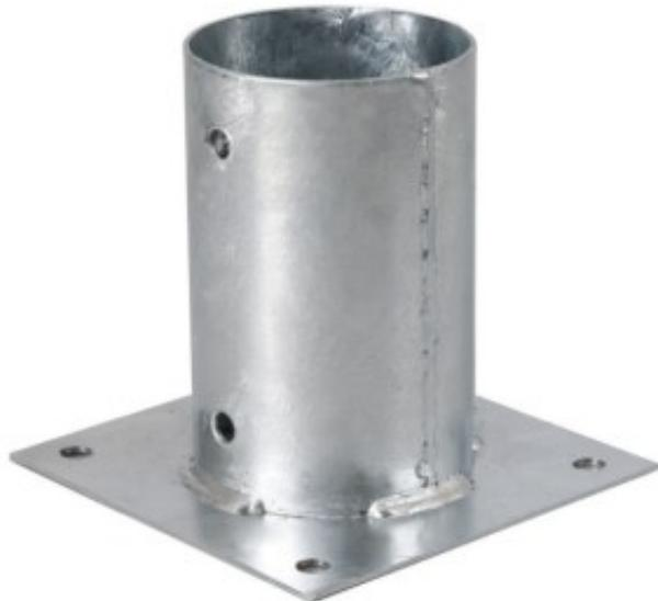
Portapilastro Tondo a Bicchiere Zincato a caldo. Con rialzo integrato e fori interni per consentire il deflusso dell'acqua. Diametro 80 mm.
