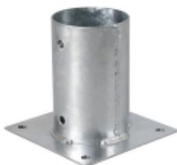
Portapilastro Tondo a Bicchiere Zincato a caldo. Con rialzo integrato e fori interni per consentire il deflusso dell'acqua. Diametro 80 mm.
