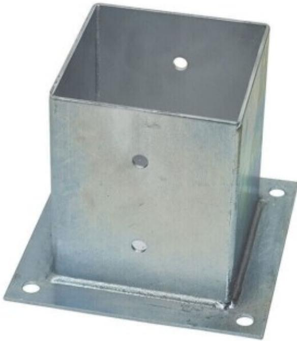
Portapilastro a Bicchiere ali esterne realizzato in ferro zincato Dimensioni interne: 161 x 161 x H 150 mm Dimensione base esterna: 240 x 240 mm Spessore: 3,5 mm Fori per il fissaggio a terra: diam. 11 mm Fori laterali per il fissaggio della trave: diam. 12,5 mm
