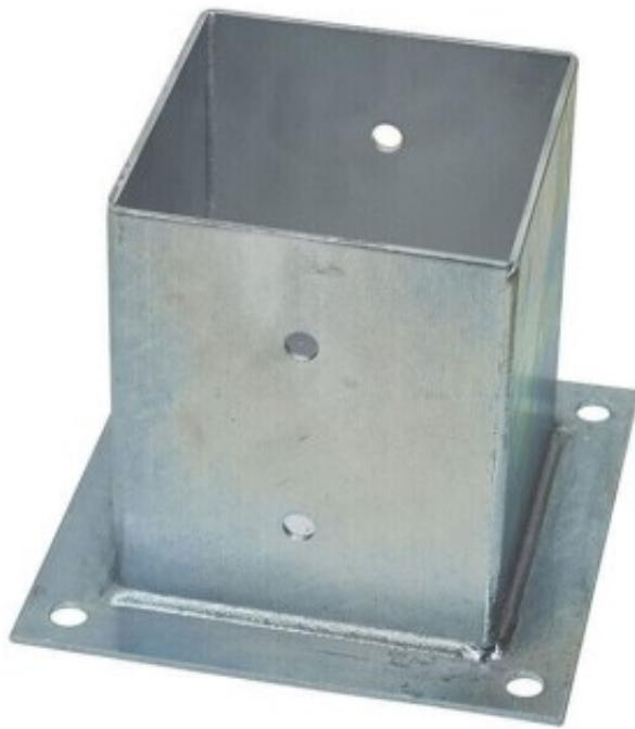
Portapilastro a Bicchiere ali esterne realizzato in ferro zincato Dimensioni interne: 141 x 141 x H 150 mm Dimensione base esterna: 240 x 240 mm Spessore: 3,5 mm Fori per il fissaggio a terra: diam. 11 mm Fori laterali per il fissaggio della trave: diam. 12,5 mm
