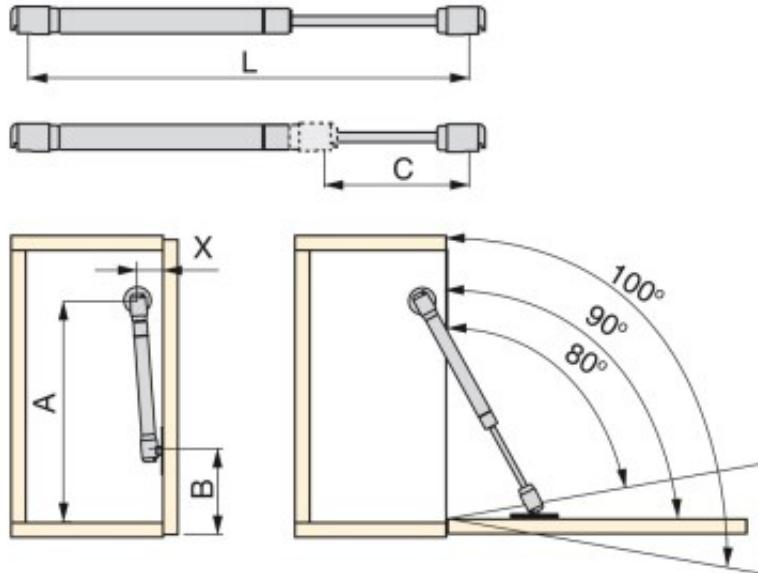
Pistone a Gas a lento rilascio di ante in caduta dei mobili, pensili da cucina, ante Vasistas, ribaltine ecc Funzionamento a gas Spinte Disponibili: 60 N equivalente a 6 kg di spinta; 80 N equivalente a 8 kg di spinta; 120 N equivalente a 12 kg di spinta
