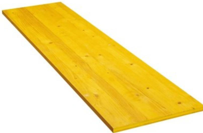
Il pannello per armatura è disponibile nella misura 50 x 300 cm. È costituito da tre strati di legno incollati fra loro. I due strati esterni in senso longitudinale e quello interno in direzione trasversale. Il pannello a tre strati LANA contribuisce a ridurre i costi delle casseforme, poiché la sua qualità consente di riutilizzarlo più e più volte; offre uno dei rapporti qualità/prezzo migliori del mercato.
