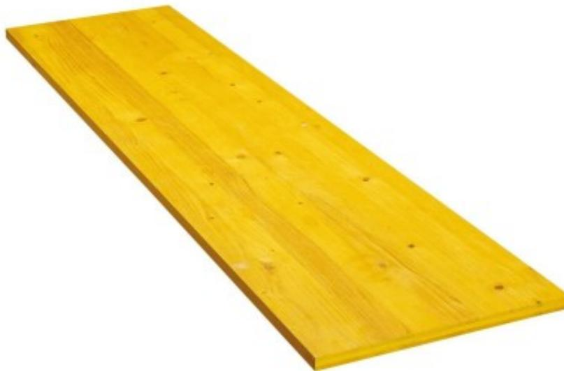
Il pannello per armatura è disponibile nella misura 50 x 150 cm. È costituito da tre strati di legno incollati fra loro. I due strati esterni in senso longitudinale e quello interno in direzione trasversale. Il pannello a tre strati LANA contribuisce a ridurre i costi delle casseforme, poiché la sua qualità consente di riutilizzarlo più e più volte; offre uno dei rapporti qualità/prezzo migliori del mercato.
