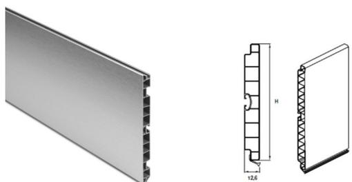
Zoccolo per cucine in pvc rivestito alluminio disponibile con altezza cm 10 - 12 - 15. Utilizzato per chiudere gli spazi tra pavimento e basi cucina, compreso di guarnizione sul pavimento per evitare infiltrazioni d'acqua e di polvere. Fissaggio rapido mediante ganci da attaccare ai piedini delle basi cucina.
