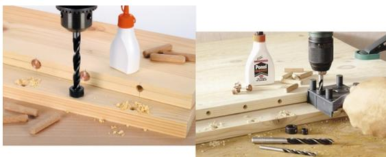
Punte per trapano con arresti di profondità Wolfcraft, presentano un punto centrale per posizionamento accurato e dotati di arresto di profondità. Realizzati in acciaio al cromo-vanadio, le punte possono essere usate per compensato, pannelli truciolari e pannelli di fibre con lo spessore tra 12 e 30 mm.
