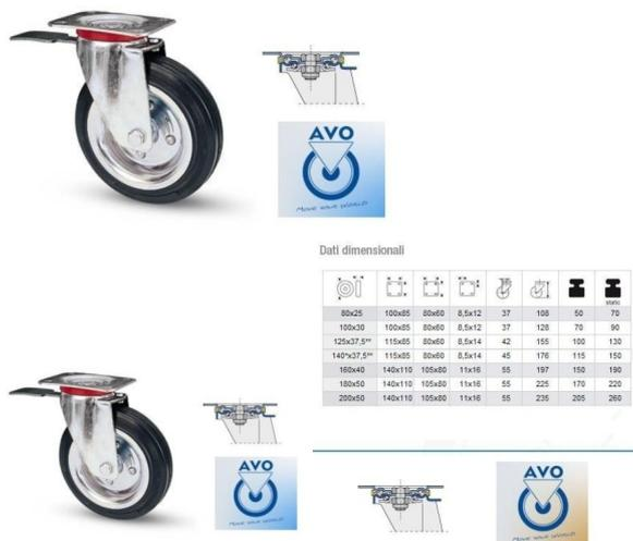
Ruote con rivestimento in gomma e flange in acciaio. Anello in gomma piena. Flange in acciaio stampato zinco-cromato. Mozzo su gabbie a rulli. Con supporto girevole e con freno. Disponibile con diametro: 80 - 100 mm
