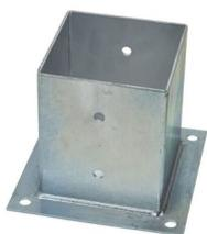
Portapilastro a Bicchiere ali esterne realizzato in ferro zincato Dimensioni interne: 161 x 161 x H 150 mm Dimensione base esterna: 240 x 240 mm Spessore: 3,5 mm Fori per il fissaggio a terra: diam. 11 mm Fori laterali per il fissaggio della trave: diam. 12,5 mm
