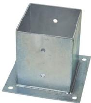
Portapilastro a Bicchiere ali esterne realizzato in ferro zincato Dimensioni interne: 141 x 141 x H 150 mm Dimensione base esterna: 240 x 240 mm Spessore: 3,5 mm Fori per il fissaggio a terra: diam. 11 mm Fori laterali per il fissaggio della trave: diam. 12,5 mm
