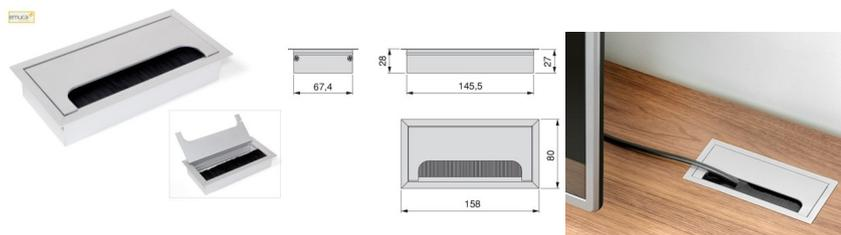
Passacavi in alluminio anodizzato opaco che permette una completa integrazione su un piano di lavoro o un tavolo in ufficio e nei mobili per la casa. Permette di passare i cavi di qualsiasi spessore e nascondere le loro connessioni in modo semplice, consentendone l'accesso in qualsiasi momento grazie alla sua copertura reclinabile e al suo spazzolino in plastica nera.
