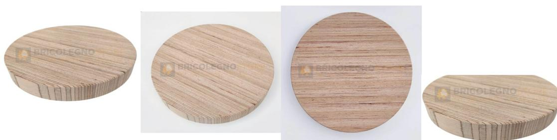
Tondo in BauBuche Tavolato è un nuovo pannello in legno microlamellare impiallacciato con legno di faggio, prodotto da Pollmeier con un metodo tecnologico. Per la sua realizzazione, fogli dallo spessore di 3 mm vengono incollati a fibre parallele o in modo incrociato e ulteriormente lavorati per ottenere travi, tavole, pannelli e pavimenti. Il Microlamellare di faggio è incollato con resina fenolica e dotato di piallacci verticali, superfici con design a linee e fughe scure, levigate.
