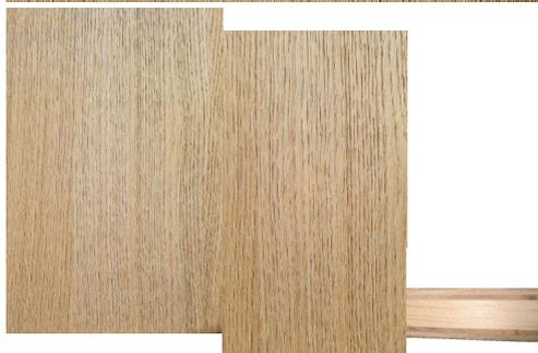
Il Listellato in Rovere Spazzolato è un pannello di produzione nazionale di alta qualità, caratterizzato da una struttura a 7 strati che garantisce maggiore stabilità strutturale. Caratteristica di questo pannello è la spazzolatura di un lato a vista, detta anche rusticatura, che risalta e definisce le venature, rendendo la superficie del legno più gradevole al tatto
