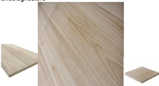
Il Lamellare Paulownia è un pannello caratterizzato per la sua leggerezza e tenerezza della sua fibra, dotato di superfici già levigate con una gradevole venatura dalla tonalità chiara. Molto usato in svariati contesti grazie alla sua versatilità e facilità di utilizzo.
