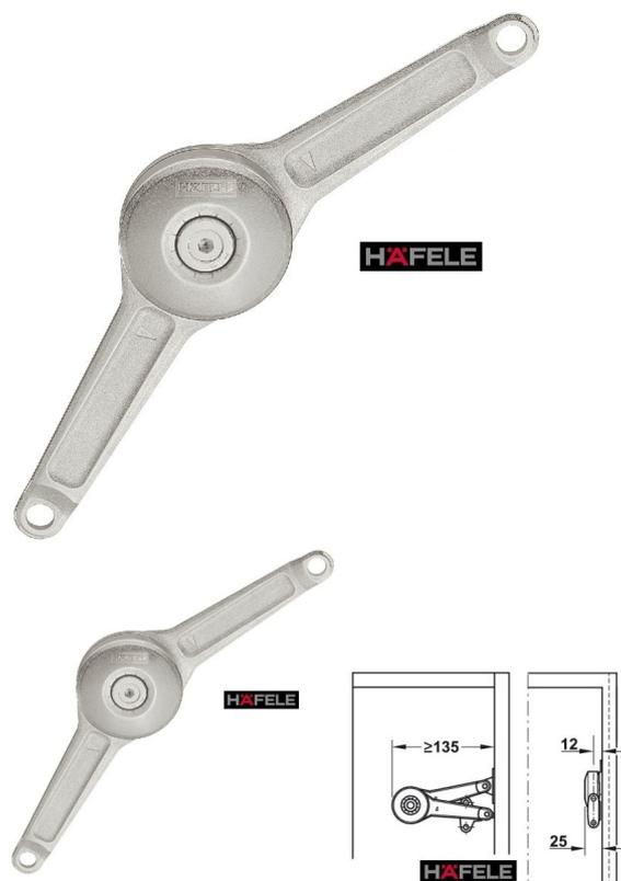
Guida snodata per ante pensili a wasistass verticale. Gestione della frizione con un chiavino (in dotazione) per regolare la forza in chiusura a secondo del peso dell'anta. Tre tipi di agganci per tutte le esigenze. Possibilità di montaggio con aperture a 75°, 90° o 100° A qualsiasi posizione si rilascia l'anta si mantiene aperta... e basterà premere per richiuderla.
