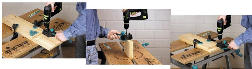
Guida rapida universale per giunzioni ad angolo, a T e di superfici piane; Per spine da 6, 8 e 10 mm; Tavole con uno spessore da 12 a 30 mm.
