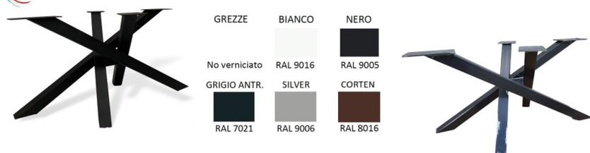
La gamba centrale per tavoli modello SHANGAI è realizzata con tubolare "Arredo" in ferro a sezione quadrangolare 80x80x3 mm. La sua forma particolare si presta per qualsiasi tipo di top come legno, marmo e vetro. La struttura è pensata per tavoli di media dimensione con misure dai 180 ai 280 cm di lunghezza e 90/100cm di larghezza. Il suo design donerà lusso e classe alle zone dove verrà collocato. Verniciatura a polvere. Varie Finiture Disponibili
