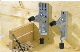
Dispositivo professionale di precisione per spinatura; Semplice serrare, forare e unire - senza misurare e marcare; Per spine da 6, 8 e 10 mm; Tavole con uno spessore da 12 a 30 mm; Per tutte le giunzioni in legno; LA confezione contiene: 1 guida per legno 2 pezzi; 1 punta per legno,  $\varnothing$  8 mm; 1 arresto di profondità,  $\varnothing$  8 mm; 40 spine,  $\varnothing$  8 mm.
