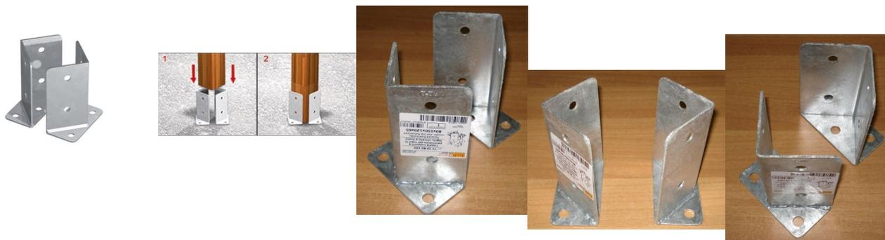
Portapilastro d'angolo in ferro zincato a fuoco, venduto a coppia. Dimensioni Base mm 65 x 120; Dimensione Angolo mm 80 x 80 x H 150. Spessore mm 3.
