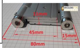
CERNIERA A MOLLA DOPPIA AZIONE Corpo in alluminio, perni tubolari in acciaio inox, lamelle di torsione in acciaio per molle Chiude la porta automaticamente Potenza di chiusura regolabile Materiale: Alluminio Altezza: 180 mm Capacità di carico con 2 cerniere: 35 kg
