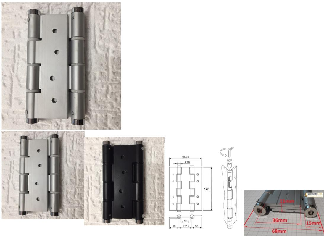
CERNIERA A MOLLA DOPPIA AZIONE Corpo in alluminio, perni tubolari in acciaio inox, lamelle di torsione in acciaio per molle Chiude la porta automaticamente Potenza di chiusura regolabile Materiale: Alluminio Altezza: 120 mm Capacità di carico con 2 cerniere: 20 kg
