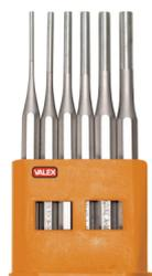
Cacciaspine in Set da 6 Pezzi CRV; In acciaio cromo vanadio temprato; Diametro punta 3 - 4 - 5 - 6 - 7 - 8 mm; Lunghezza 150mm.
