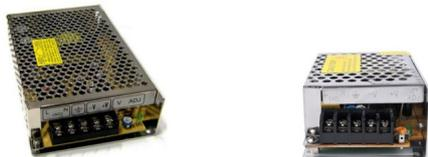
Alimentatore stabilizzato per lampadine a led. Grazie alla corrente erogata pari a 2A, sarà possibile collegare 100 lampadine led da 0,02A
