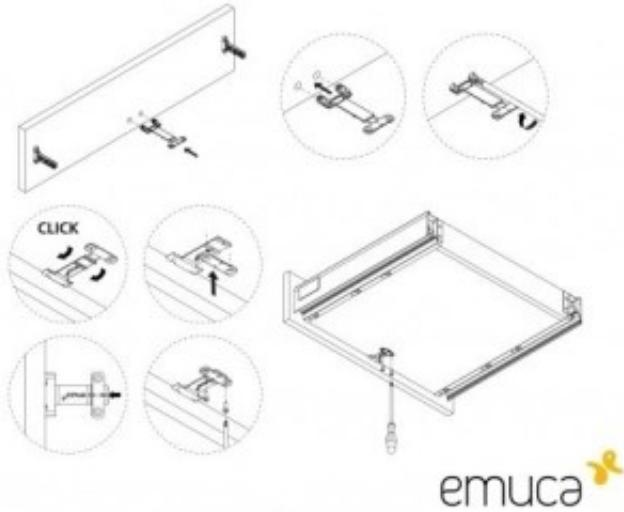
Unione frontino-fondo Lokbox Emuca . Serve a fissare il fondo del cassetto al frontale senza impedire la regolazione dello stesso. Compatibile con qualsiasi cassetto, particolarmente adatto per cassetti abbastanza larghi utilizzati nelle cucine, bagni e persino negli interni di armadio.
