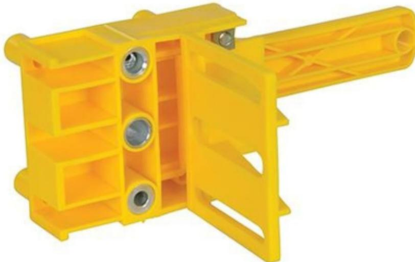
Guida per spinatura per produrre giunzioni a E, L e T; Per spine da 6, 8 e 10 mm fino a 30 mm di spessore; Fora entrambe le parti della giunzione simultaneamente per risultati perfetti; Adatto per l'utilizzo con trapano manuale ed elettrico.
