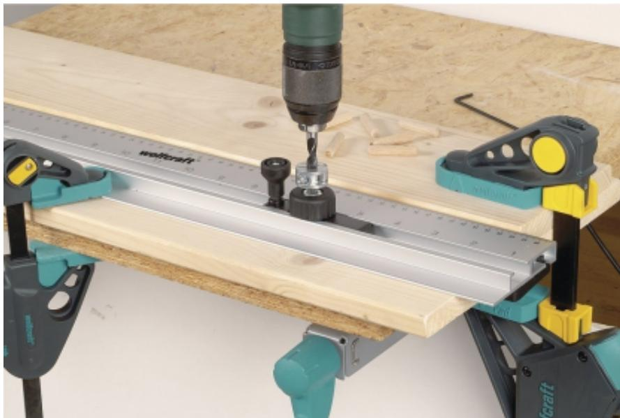
Guida per spinature, serie di fori per scaffali / armadi, fori per cerniere ed accessori per mobili; Per spinare in serie tavole con una lunghezza massima di 600 mm; Con un unico serraggio e con uno spessore da 12 a 40 mm; Con bussole di foratura intercambiabili con Diametro di 5, 6, 8 e 10 mm; Interasse dei fori di 32 mm.
