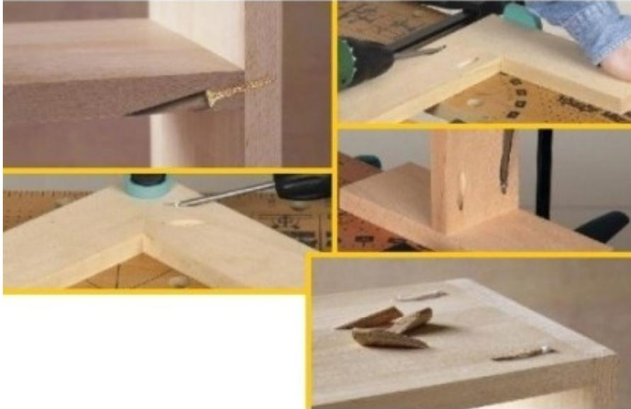
3 semplici mosse per collegare i pezzi da lavorare in modo veloce, preciso e stabile. Questa guisa permette di forare in maniera accurata unendo con viti a scomparsa 2 pannelli ottenendo un collegamento stabile e preciso.
