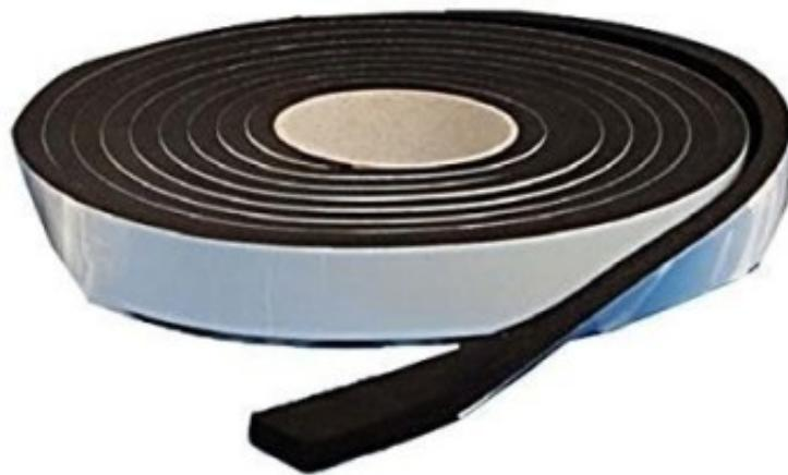
Guardinzione autoadesiva ideale per: avvolgere tubi di riscaldamento e componenti varie (valvole); sigillare i vari tipi di coppelle dopo la posa in opera; sigillare contro le infiltrazioni di acqua e aria in genere. Rotolo da 10 MT. Spessore 3 mm. Larghezza 50 mm
