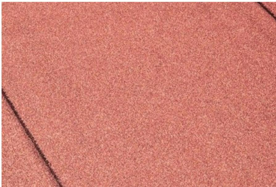
La membrana ardesiata, fornibile standard o adesiva, si differenzia da quelle normali in particolare per la finitura superficiale, che ne allunga la durata e ne migliora l'aspetto estetico. Oltre alla buona impermeabilizzazione, coadiuva l'isolamento termico e garantisce maggiore durata alla struttura.
