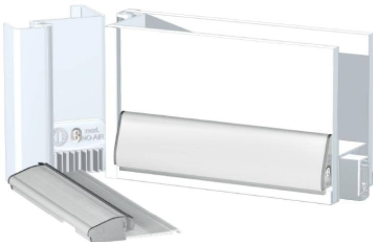
Sistema ideato per l'installazione anche su porte già esistenti dove sia necessario inserire una soglia drenante. Il sistema può essere completato con l'utilizzo del gocciolatoio Ulysse Drip che grazie alla spazzola in polipropilene con pinna contribuisce a aumentare la tenuta dell'acqua. Facile da montare. Disponibile in tre lunghezze: 103 - 133 - 163
