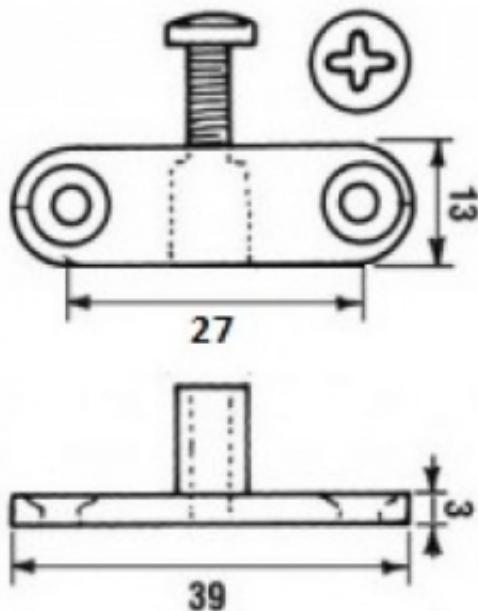
Giunzione in zama a 90° per facili assemblaggi di strutture in legno
