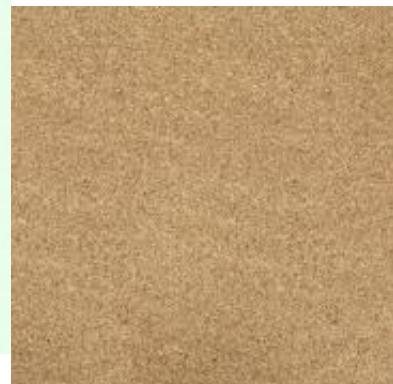
Pacco da 40 fogli di sughero dello spessore di 4 mm. Formato cm 50 x 100. Un pacco corrisponde a 20 metri quadrati. Il sughero è un prodotto naturale, antistatico, antiallergico, biocompatibile. E' usato soprattutto come isolante termico, insonorizzante e fonoassorbente. Al contrario di altri isolanti sintetici il sughero non rilascia solventi o particelle nocive. Il sughero è gradevole al tatto e può essere posato a vista.
