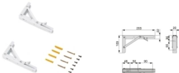
Set di 2 staffe pieghevoli per posizionare le mensole a parete. Disponibile nelle misure da 203mm/303mm/403mm con una capacità di carico massima di 40, 50 o 60 kg per ogni ripiano con due staffe.
