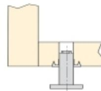
Piedino regolabile per mobili. Progettato per regolare e livellare ogni tipo di mobile con una semplice regolazione dall'esterno del mobile. Inoltre ha la possibilità di essere regolato dall'interno del mobile grazie alla sua chiave 4 esagonale, facendo un foro passante. Dispone di una vite M10 e un coperchio circolare D 23 mm di plastica colore nero. Per il montaggio è necessario una bussola M10.
