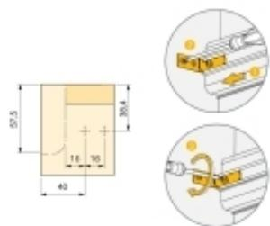
Kit di profili Gola per frontali di modulo senza maniglia. Il kit è composto da tutti gli accessori necessari per effettuare il montaggio, costituito
